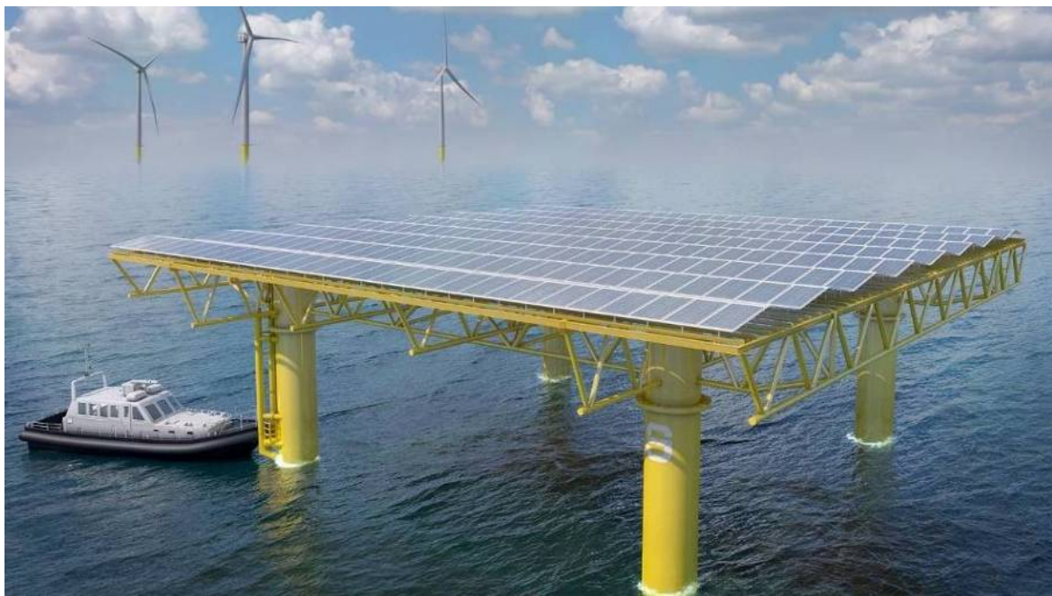
图 7.3-1 钢管桩+钢桁架方案示意图
